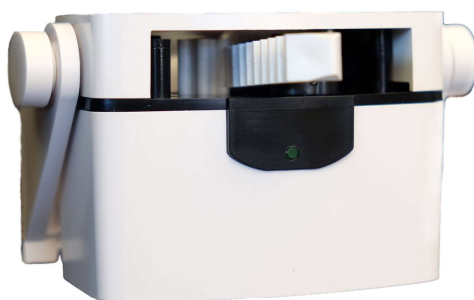
Obrázek #4: Správně zasunutý hřeben mezi ozubené kolo a přítlačnou páčku
